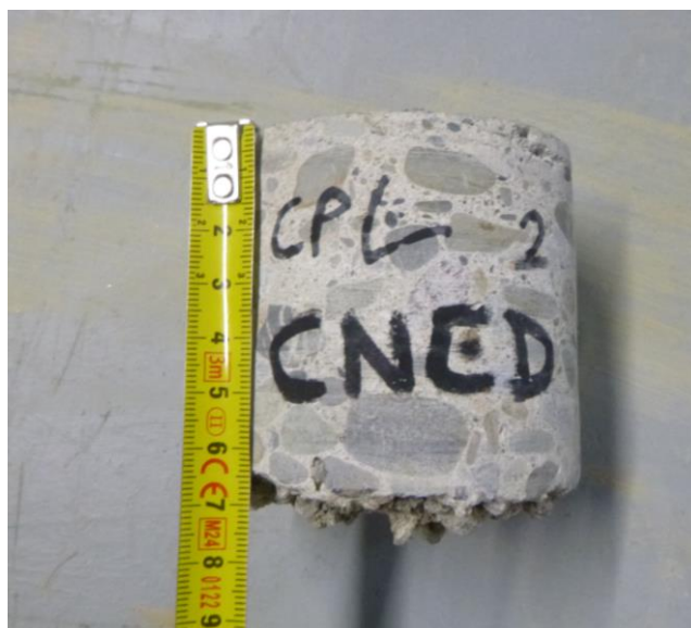
Sondage carotté dallage – zone centrale
